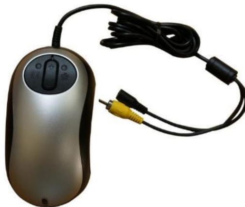
Slika 7. Uređaj u obliku računalnog miša s mogućnošću povećanja željenog materijala (LVI, n. d.)
