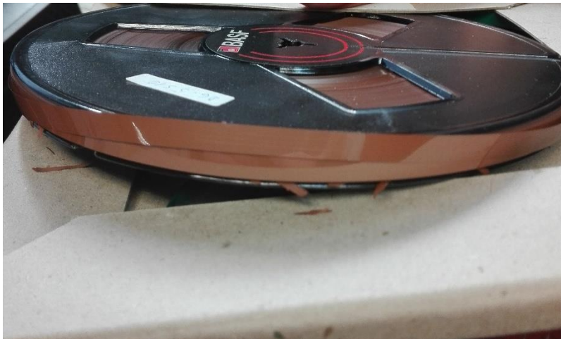
Slika 4. Magnetska vrpca s oštećene površine (fotografirano 3. 2. 2023. u Arhivu HRT-a)
