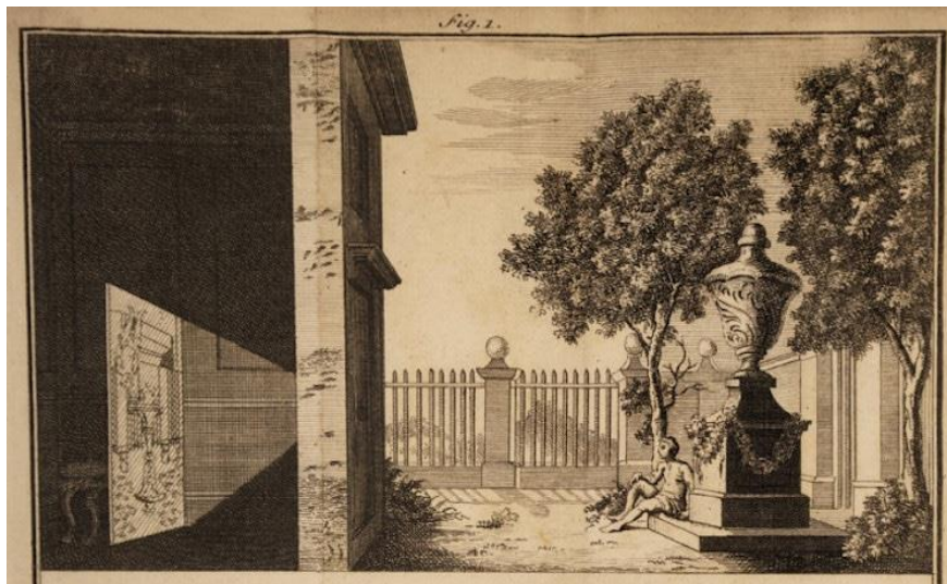
Slika 1. Princip rada Camerae Obscurae, koje je ilustrirao James Ayscough u "Kratkom prikazu oka i prirodi vida", 1755. ( https://mymodernmet.com/camera-obscura/ - pristupila 31.5.2023. u 17h)
