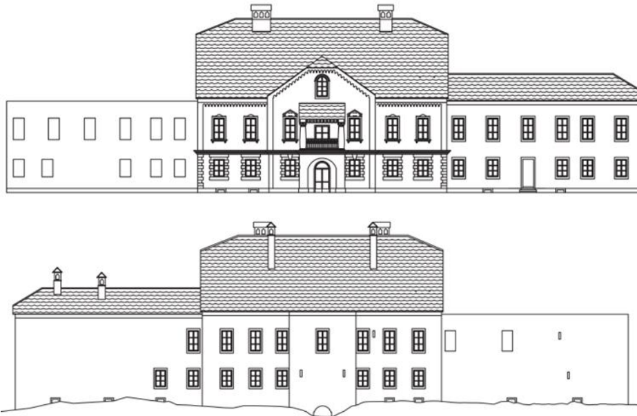
Slika 15: Arhitektonska snimka zapadnog i istočnog pročelja, Tehnozone , 2007.
