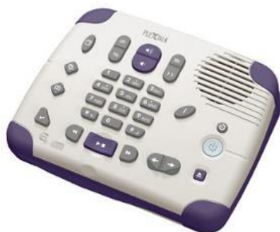
Slika 14. Plextor Plectalk uređaj za reprodukciju audio knjiga
