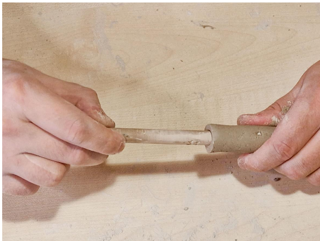
Slika 8. Bušenje rupe za čašicu
