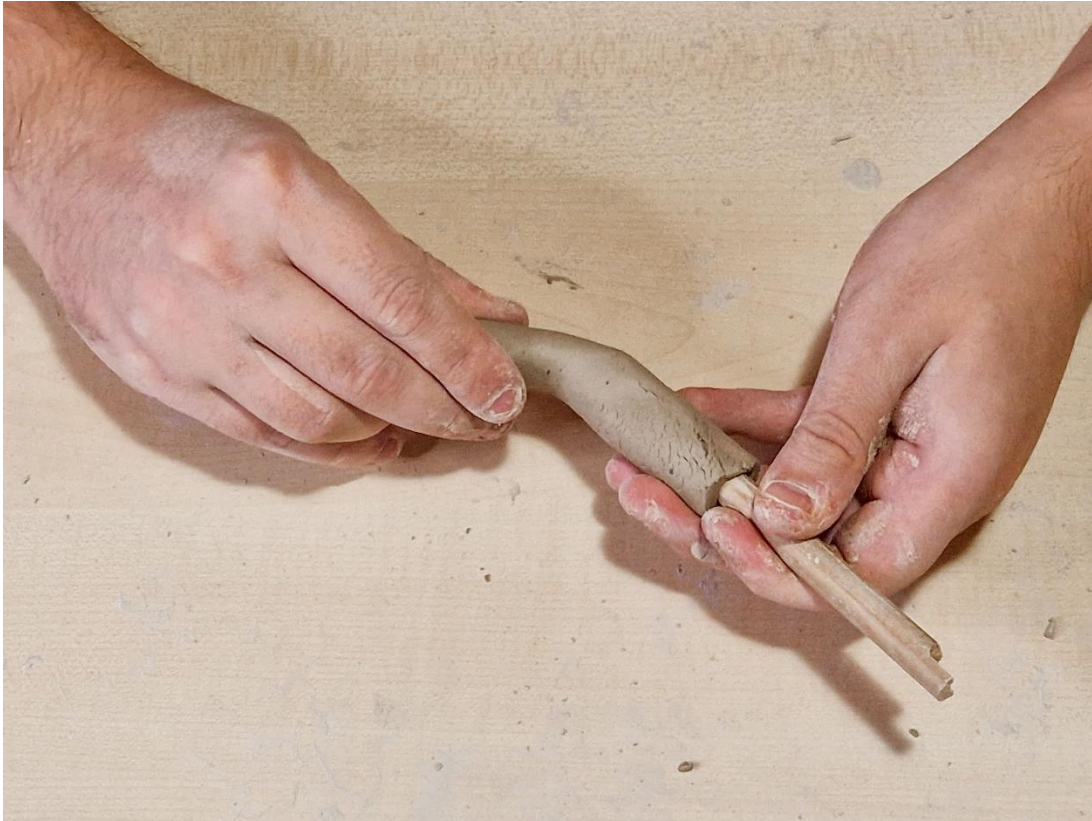
Slika 9. Savijanje donjeg dijela lule kako bi se dobio tuljac
