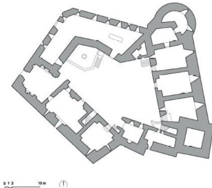
Slika 36. Tlocrt kaštela u Pazinu (Izvor: Višnjić, Josip: Istarske feudalne rezidencijalne utvrde tijekom kasnog srednjeg i ranog novog vijeka (15.-17. stoljeće), u: Istra u novom vijeku, uredila: Tatjana Bradara, Pula, 2017.)
