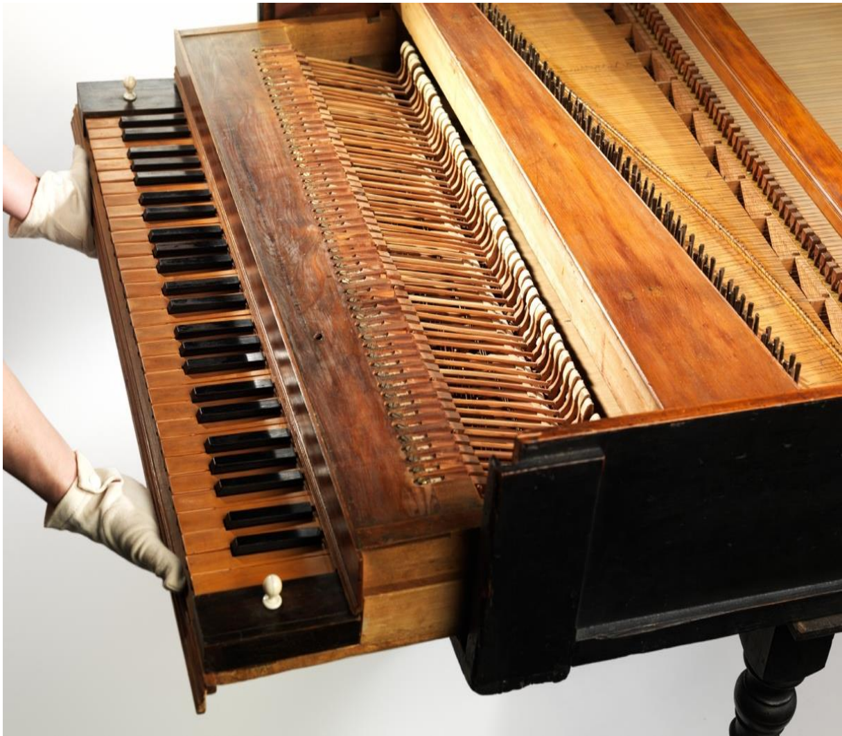
Slika 3. Mehanika s batićima na najstarijem sačuvanom glasoviru Bartolomea Cristoforija (izvor: Metropolitan Museum of Arts u New Yorku).
