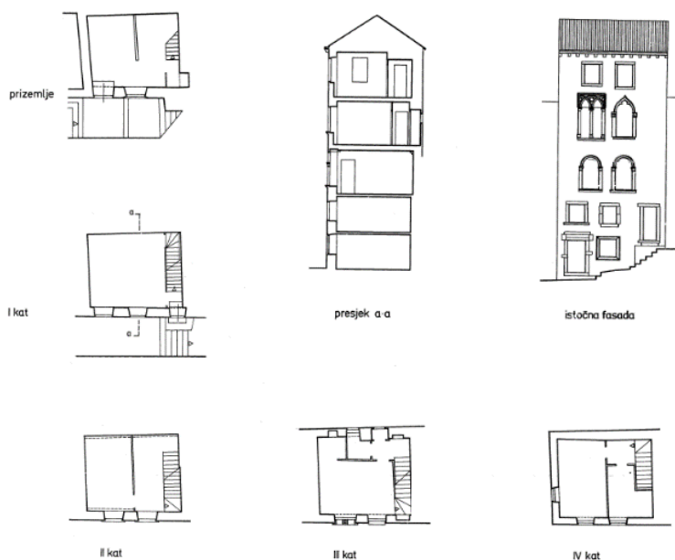
Slika 3.6. Kovačka 13, pročelje, presjek i tlocrti etaža, stanje iz 1971./72. (Planoteka IPU 92/227A 1, autor: Ivan Tenšek)
