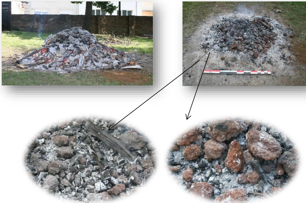
Slika 4. Tijek postupka prženja rude – nakon 2 sata gorenja i pred kraj prženja. Vidljivi ostaci pougljenog drva i pepela te promjena boje rude
