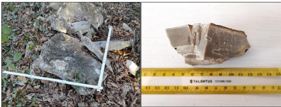
Slika 12. Lijevo: suhozid s pločastim rožnjakom na gornjoj plohi. Desno: uzorak pločastog rožnjaka iz suhozida.
