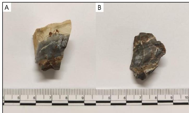
Sirovina pod brojem 2 potječe s poluotoka Marlera, što pokazuje makroskopska usporedba s uzorcima sakupljenim na ovom sekundarnom ležištu. Riječ je o laminiranom dijagenetskom rožnjaku sivkasto-plave boje. Za mikropetrografsку analizu određeni su uzorci K-3 i K-4 (slika 74).
