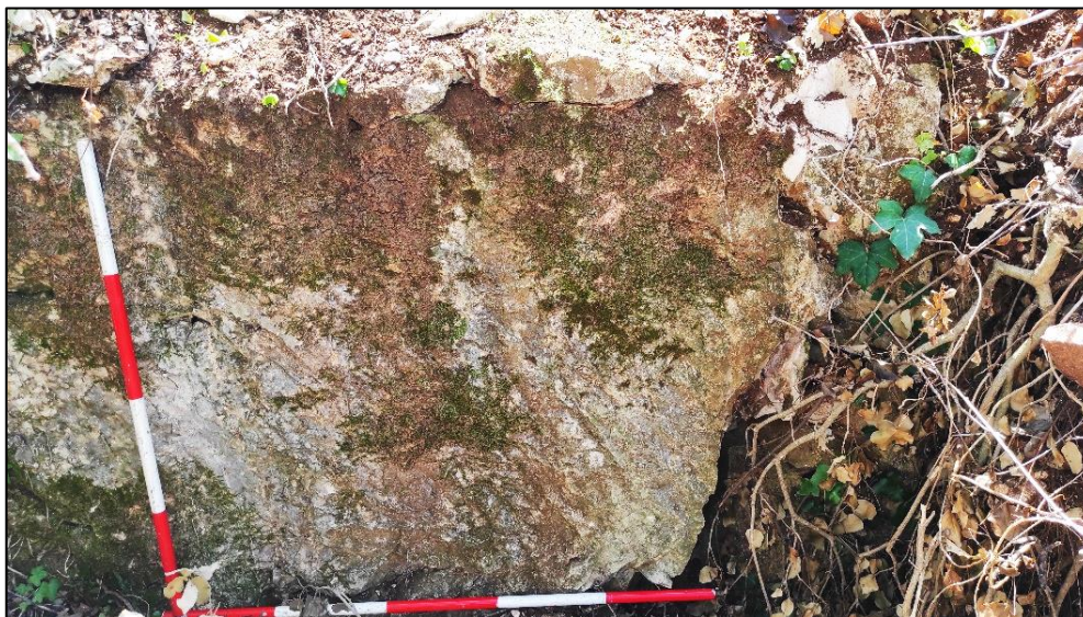
Slika 110. Ravno istočno lice kamenoloma s tragovima alata.
