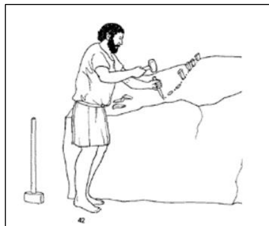
Slika 186. Cijepanje kamenog bloka pomoću klinova (preuzeto iz ADAM 2005, 39).
