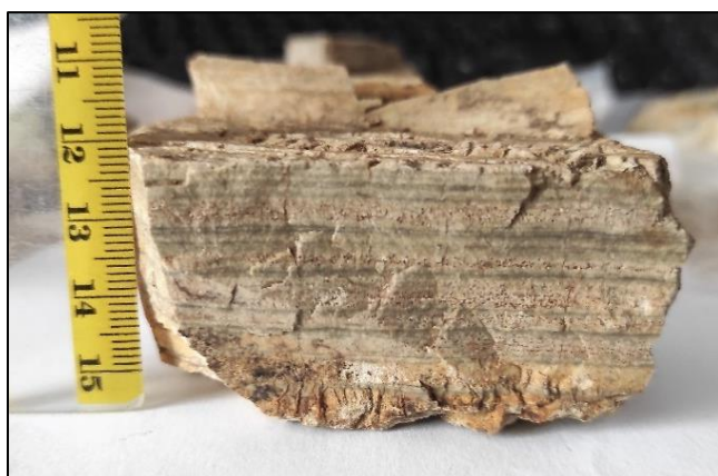
Slika 8. Laminirana tekstura rožnjaka pronađenog u zemljanom profilu, Trebišća.
