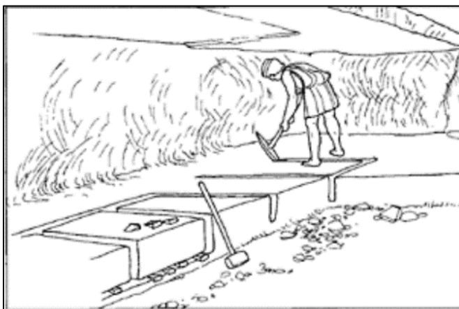
Slika 185. Ekstrakcija kamenih blokova pomoću pašarina i klinova (preuzeto iz ADAM 2005, 32).
