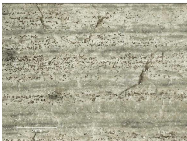
Slika 9. Karakteristična laminirana tekstura rožnjaka s Trebišća. Povećanje 6 puta, mjerka je duljine 5 mm.
