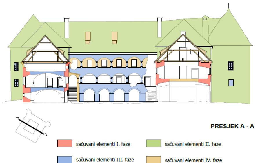
Slika 34. Prikaz faza izgradnja na sjeveroistočnom dvorišnom pročelju, postojeće stanje, 2021.
