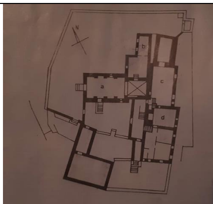
sl. 3. Tlocrt prizemlja samostana (Zavod za zaštitu spomenika Zadar) a. crkva, b. ostaci romaničkog trijema, c. refektorij, d. kuhinja
