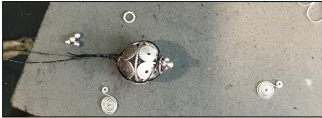
Slika 64 Prikaz željezne žice kojom se spajaju dva polukružna dijela
