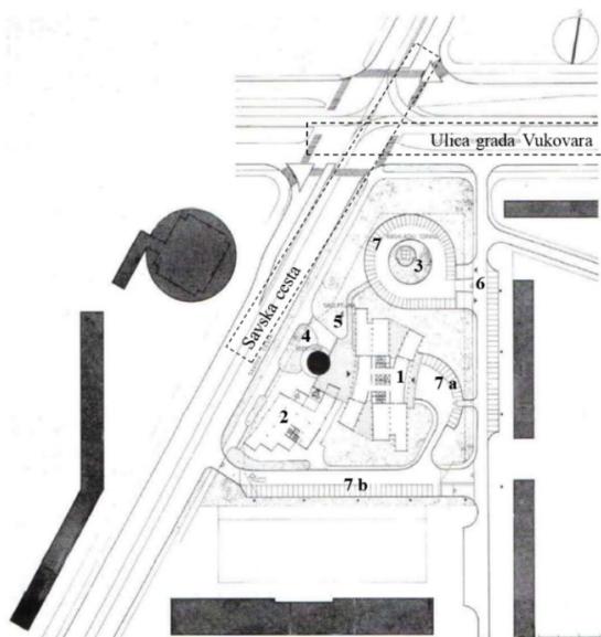
Slika 25. Shematski prikaz smještaja objekta i popratnih sadržaja na parceli. 1-poslovni toranj, 2-aneks, 3-rashladni toranj, 4-javni prostor, 5-planirani položaj skulpture, 6- ulaz i izlaz iz podzemne garaže, 7-kružno parkiralište, 7a -parkiralište s istočne strane, 7b-parkiralište s južne strane. Ucrtala autorica.
