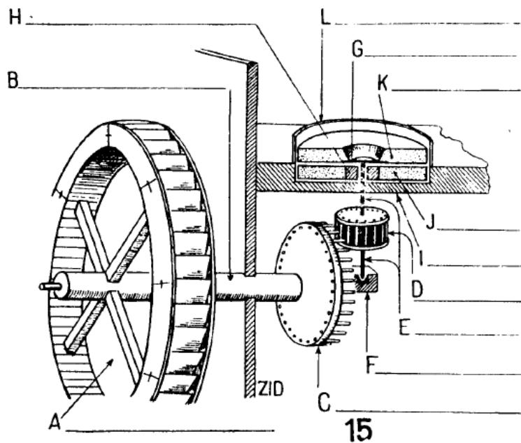
Sl. 16. Crtež mlinskog mehanizma mлина s vertikalnim tipom kola, kakvog je imao mlin br. 35 (mlin Grab) u Bjeljavini u Starom Selu Topusko, na kojemu su velikim slovima označeni njegovi sljedeći dijelovi: A - veliko kolo; B - vreteno; C - malo kolo ili zupčanik s palcima; D - šiška; E - osovina; J - donji statični mlinski kamen; K - gornji pokretni mlinski kamen; L - kućište s mlinskim kamenovima (Žlimen 1963: 72).
