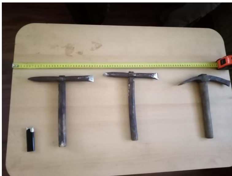
Sl. 20. Alati korišteni za izradu i popravljivanje vodenica u Maličkoj (na slici lijevo i u sredini su sječivice , a desno je tesla ). Snimljeno u kući kazivačice M. L. u Maličkoj (snimila: Dora Hornik, 26. 2. 2020.).
