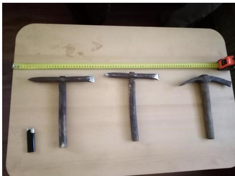
Sl. 20. Alati korišteni za izradu i popravljanje vodenica u Maličkoj (na slici lijevo i u sredini su *sječivice*, a desno je *tesla*). Snimljeno u kući kazivačice M. L. u Maličkoj (snimila: Dora Hornik, 26. 2. 2020.).
