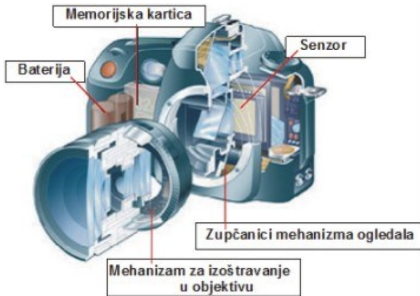
Slika 5. Dijelovi digitalnog fotoaparata (Izvor: https://unze.ba/am/pzi/2009/PopovicDarko/digitalni_aparat.html )
