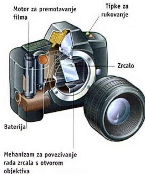
Slika 3. Dijelovi analognog fotoaparata (Izvor: http://www.mrdjenovic.com teme/obiljezja-savremenih-fotoaparata/ )
