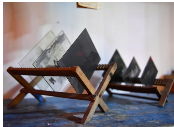
Sl. 22. Prezentacija drvene sušilice za staklene negative, unutrašnjost foto-atelijera i galerije Pelikan u Celju, Slovenija; Izvor: mrežne stranice Muzeja novejšje zgodovine Celje ( https://www.muzej-nz-ce.si/stalne-razstave/fotoatelj-in-galerija-pelikan-stekleni-fotografski-atelj-s-konca-19-stoletja/ )
