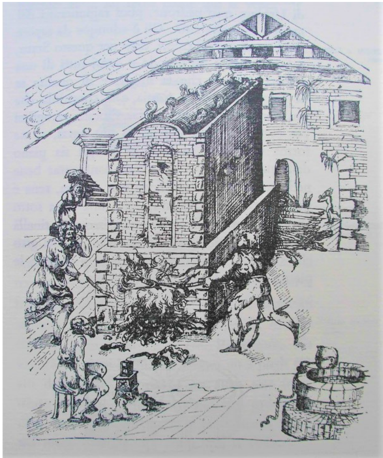
Slika 10. Peć u pogonu. Piccolpasso, Li tre libri dell'arte del vasaio , polovica 16. st.
