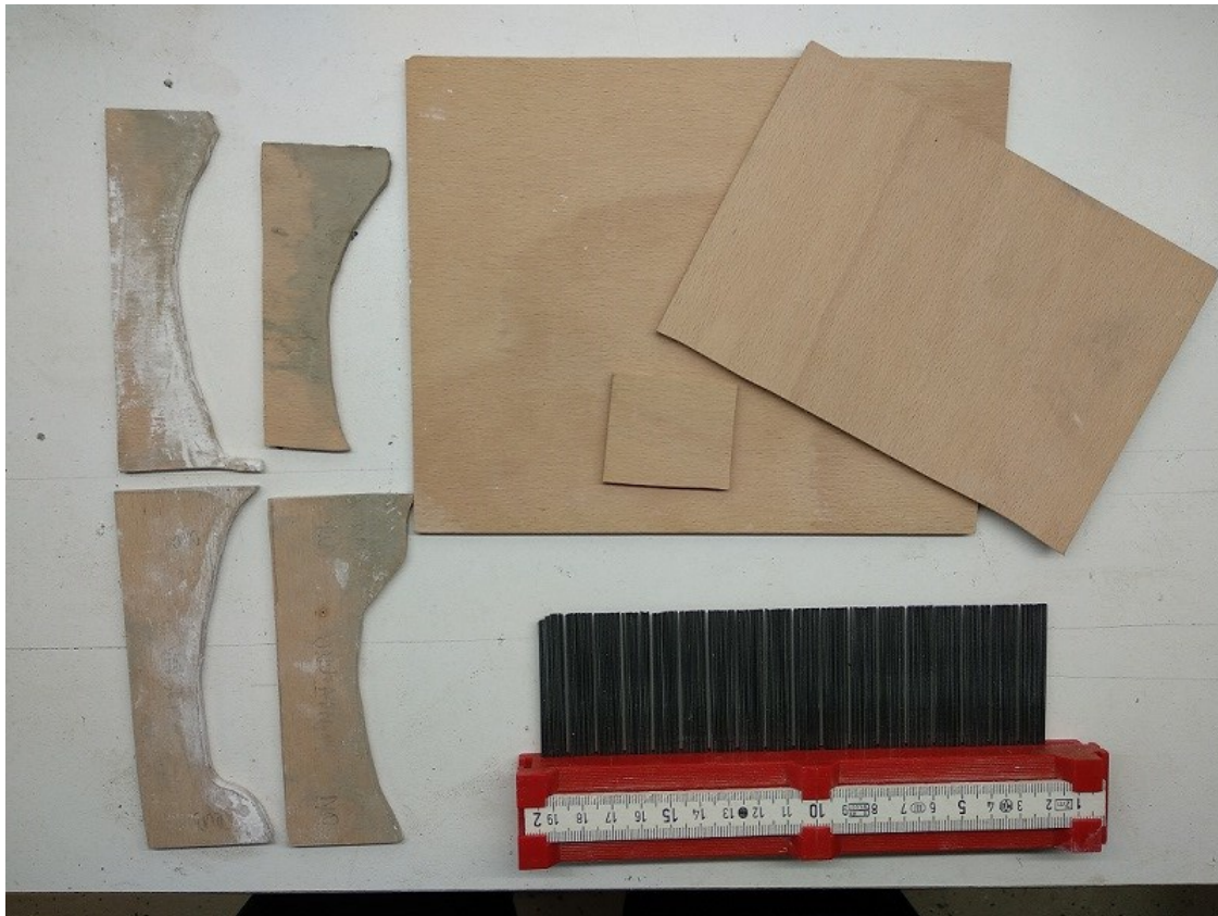
Slika 6. Česalj za uzimanje profila posude i šperploče
