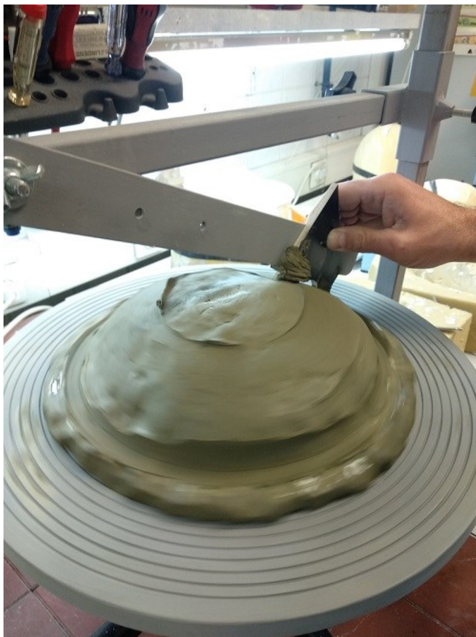
Slika 11. Nalaz 826 v1), izrada modela u glini na lončarskom kolu uz pomoć šperploče unutarnjeg profila
