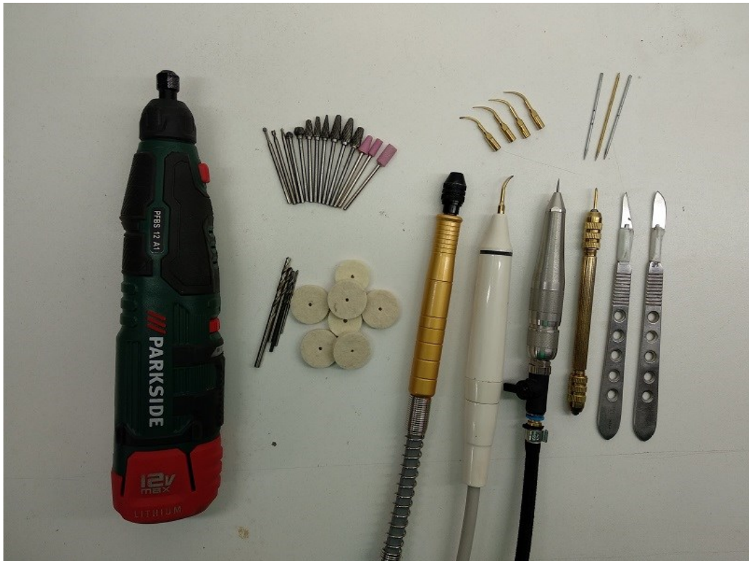
Slika 4. Alati za mehaničko skidanje nečistoća s keramike i za izradu ukrasa
