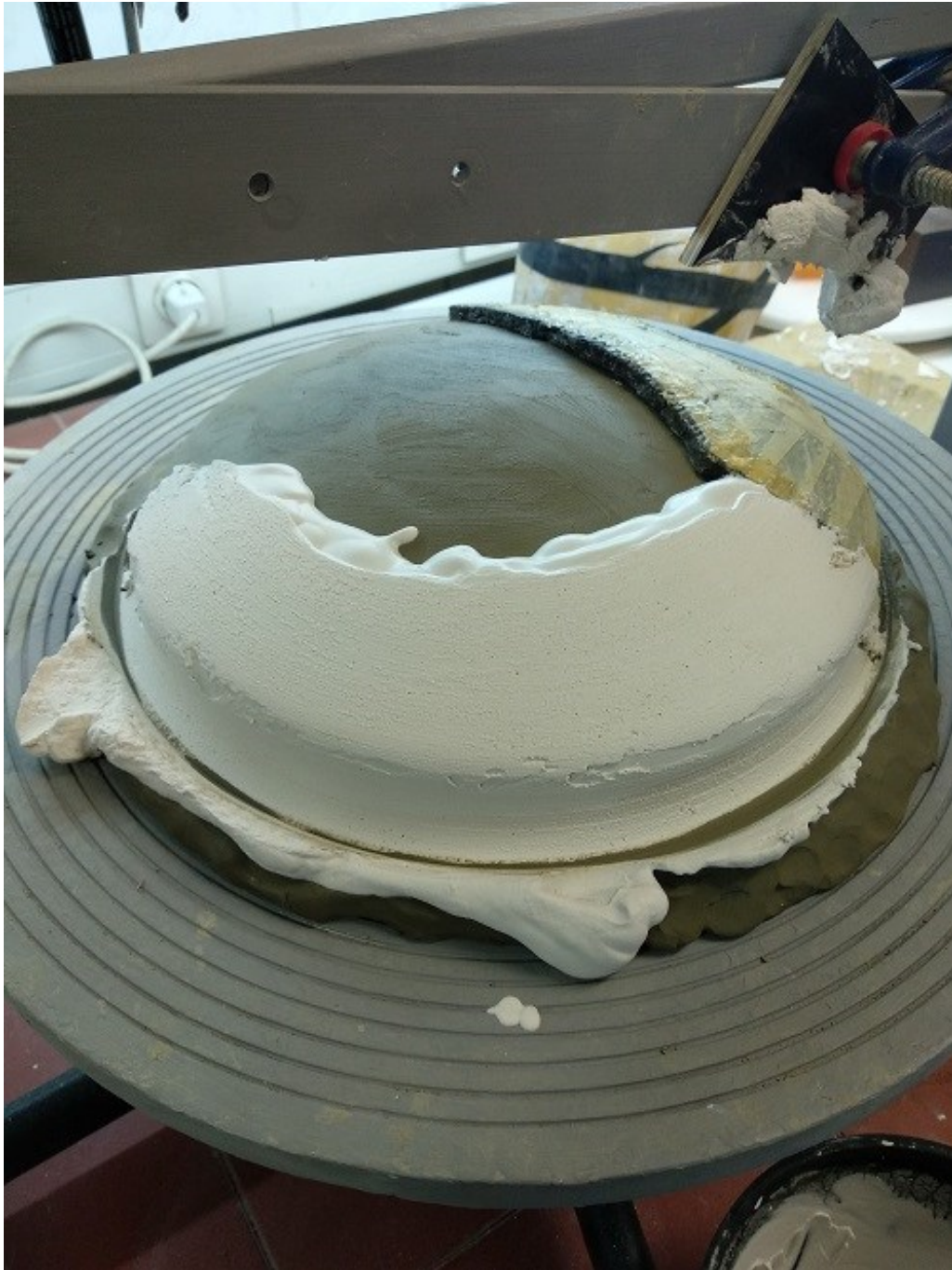
Slika 12. Nalaz 826 v1), gipsanje glinenog modela uz pomoć šperploče vanjskog profila
