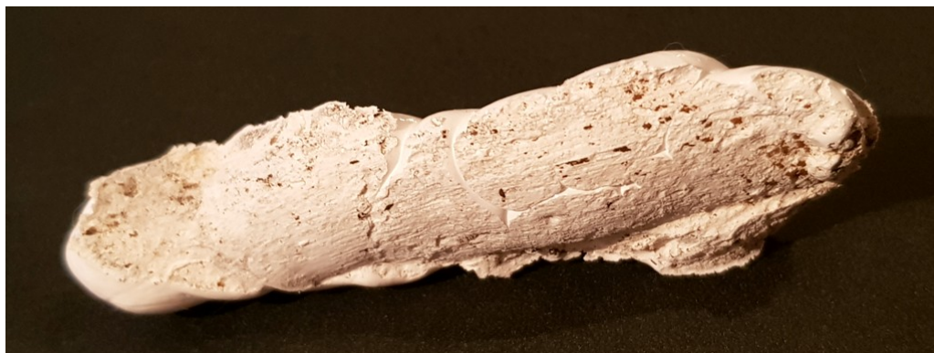
Slika 11. Tragovi linija na silikonu s utiska D
