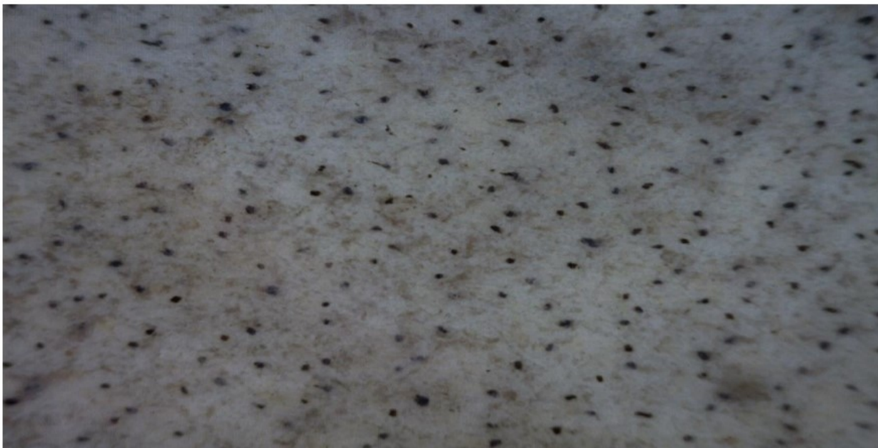
Sl. 11. Struktura površine kože kojom je pisan Dubrovačkog statuta povećana 200 puta IR elektronskim mikroskopom
