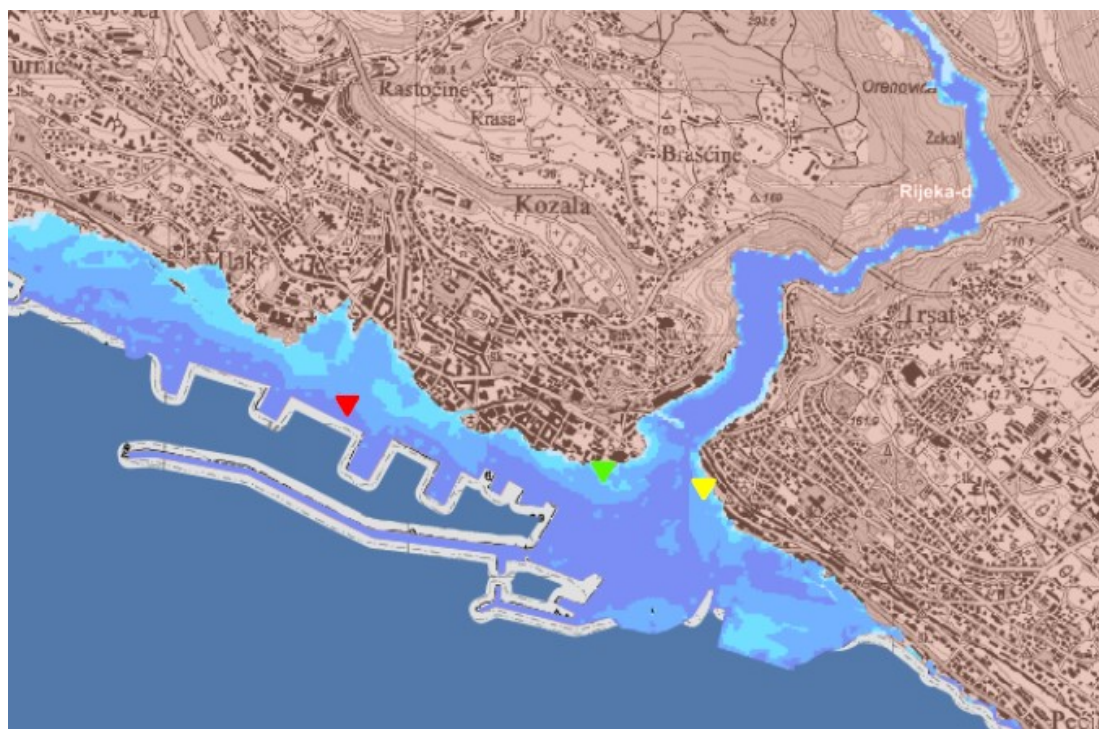
Slika 22. Karta rizika od poplave (mala vjerojatnost poplavlivanja): skladišta su označena crvenim, crkva zelenim i palača žutim trokutom
