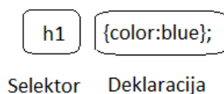
Slika 24. Selektor i deklaracija CSS sintakse. Izvor:
