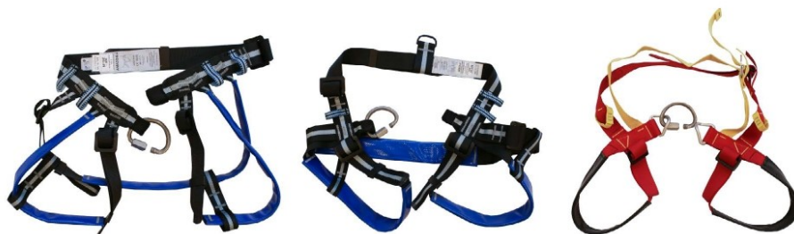
Slika 10.14 | Speleološki pojasevi s ispravno ukopčanim centralnim karabinerima, tako da se matica zatvara smjerom prema dolje, što je važno kod nošenja transportne vreće na centralnom karabineru
