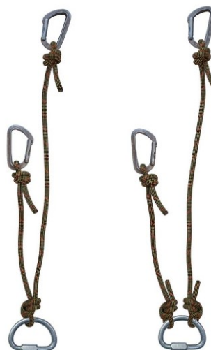
Slika 10.17 | Pupčana vrpca – kraći krak služi za ukopčanje u sidrište prilikom njegovog prelaska, a duži krak ukopčan je u karabiner ručne penjalice (kao osiguranje) ili se koristi prilikom prelaska priječnica i gelendera te za potrebe osiguravanja
