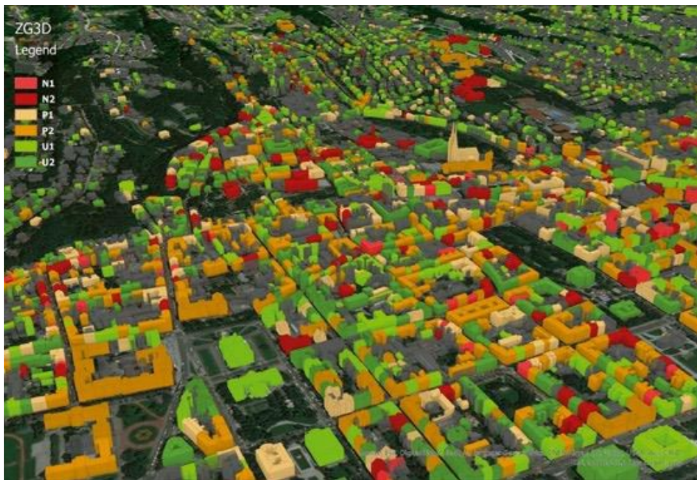
Slika 10. 3D prikaz oštećenja građevina Donjeg grada prema oznaci procjene uporabljivosti
