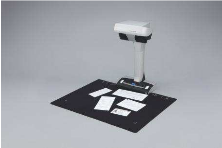
Slika 2. Skener Fujitsu ScanSnap SV600 s podmetačem i pokretnom glavom za skeniranje
