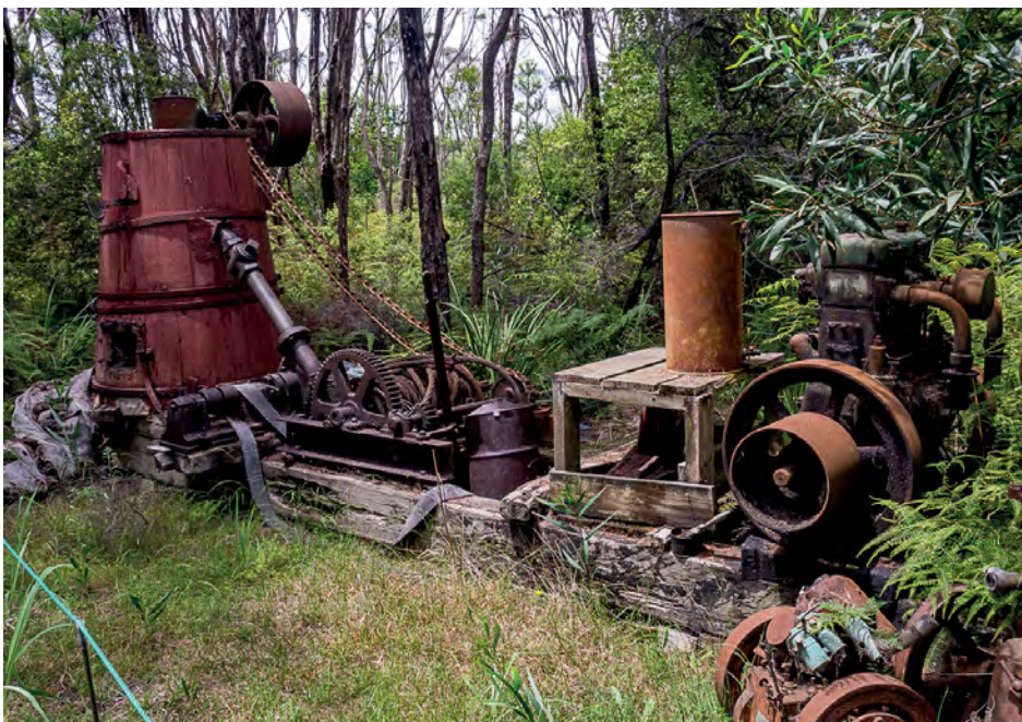
Stroj za čišćenje smole drveta kauri koji se rabio nakon 1930. godine, Gumdiggers Park u blizini grada Kaitaia (fotografija: Rhonda Albom)
