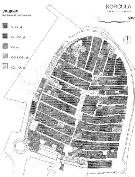
Slika 2.6. Ulična mreža Korčule s ucrtanim povijesnim slojevima građevina (izvor: Zelić, ur., „Ornamente od svijeta, famoza Korčulo“. Na putu sagledavanja urbanističke cjeline Korčule, 27)
