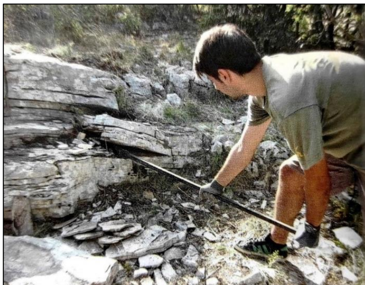
Slika 189. Primjer vađenja pločastog vapnenca na Učki modernim alatom (preuzeto iz BODROŽIĆ I DR. 2018, 50).
