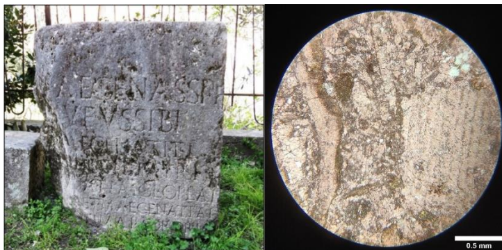
Lijevo: Slika 221. Nadgrobni spomenik Mecenata Rufa - uzorak FV-5 (fotografija: Silvana Petešić). Desno: Mikrofotografija 44. Uzorak FV-5, paralelni nikoli, povećanje 40x.
