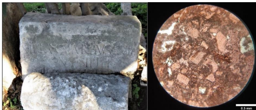
Lijevo: Slika 222. Spomenik Vibije Arbuskule - uzorak FV-6 (fotografija: Silvana Petešić). Desno: Mikrofotografija 45. Uzorak FV-6, paralelni nikoli, povećanje 40x.
