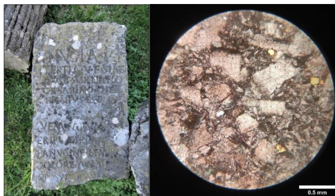
Lijevo: Slika 224. Stela Anusije Tercije i Tita Sornacija - uzorak FV-8 (fotografija: Silvana Petešić). Desno: Mikrofotografija 47. Uzorak FV-8, paralelni nikoli, povećanje 40x.
