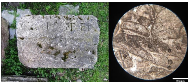
Lijevo: Slika 223. Arhitrav s natpisom - uzorak FV-7 (fotografija: Silvana Petešić). Desno: Mikrofotografija 46. Uzorak FV-7, paralelni nikoli, povećanje 40x.
