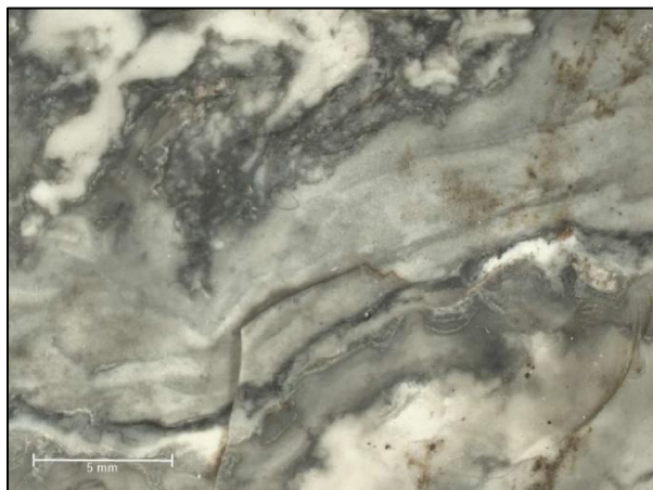
Slika 35. Karakterističan izgled sirovine s Marlere. Povećanje 6x, mjerka je duljine 5 mm.
