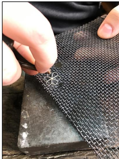
Slika 44 Stavljanje filigranskog praha na žicu
