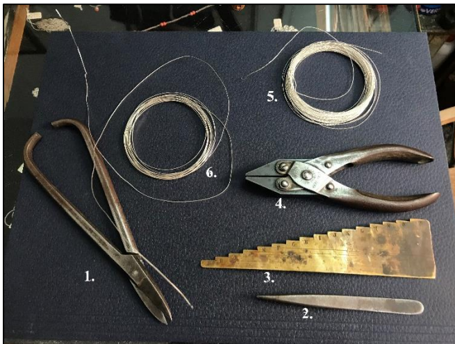
Slika 21 Alati za oblikovanje baze (1. škariće za rezanje žice, 2. pinceta, 3. skalica - uz pomoć nje se mjere jednake dužine latica, 4. paralelna kliješta, 5. i 6. srebrna žica
