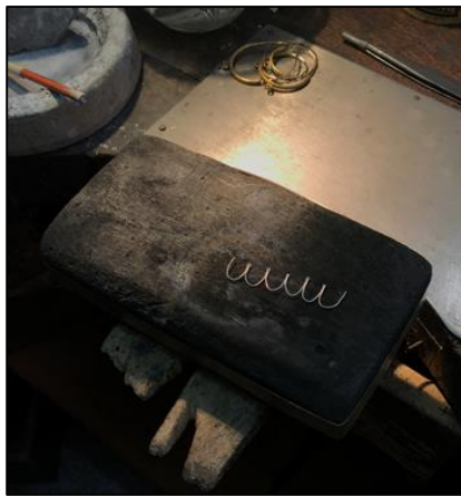
Slika 35 Srebrna žica na podlozi od ugljena
