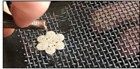
Slika 52 Stavljanje filigranskog praha
