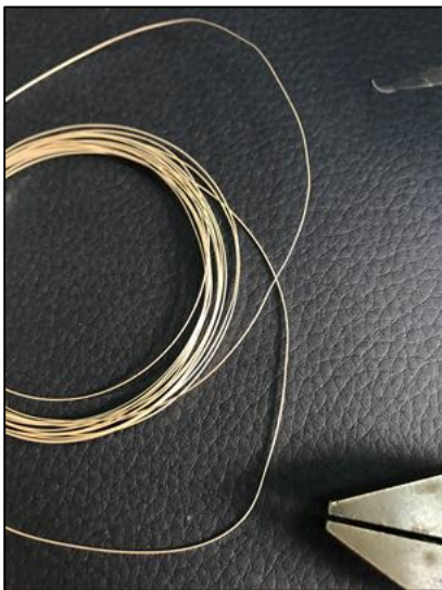
Slika 24 Srebrna spljoštena žica, služi za oblikovanje baze
