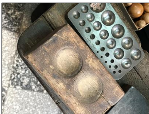
Slika 29 Drveni i metalni kalup za "bolcne"
