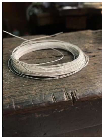
Slika 23 Dvije prepletene, spljoštene srebrne žice, služi za oblikovanje punjenja
