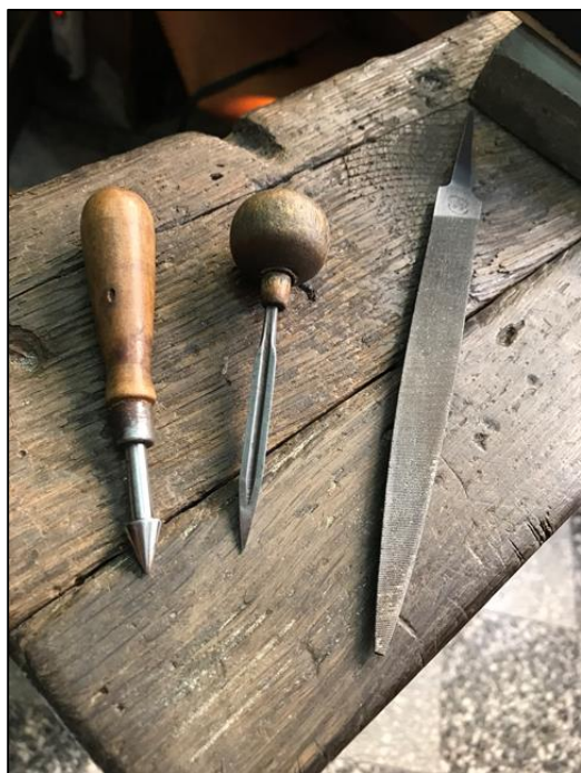
Slika 33 Alati za poliranje završnog proizvoda - naušnica (S lijeve strane nalazi se alat imena polirstein , u središtu se nalazi šaber, a s desne strane je turpija, može se koristiti i glas papir)
