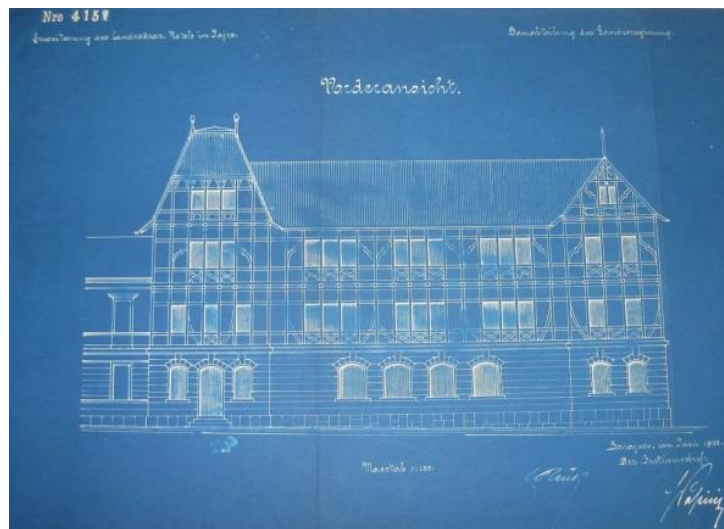
Slika br.112. Izvedbeni projekt dogradnje, sjeverna fasada, 1:100, 1908.
