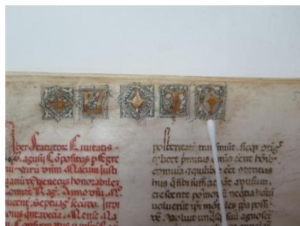
Sl. 13. Ispitivanje topljivosti tinte u etanolu
