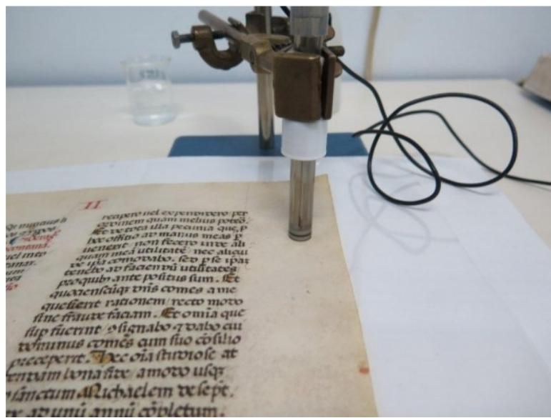
Sl. 16. Površinsko mjerjenje pH vrijednosti na listu broj 26
