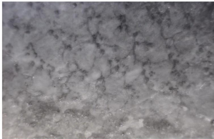
Sl. 10. Struktura površine izvorne kože s Dubrovačkog statute povećana 200 puta IR elektronskim mikroskopom
