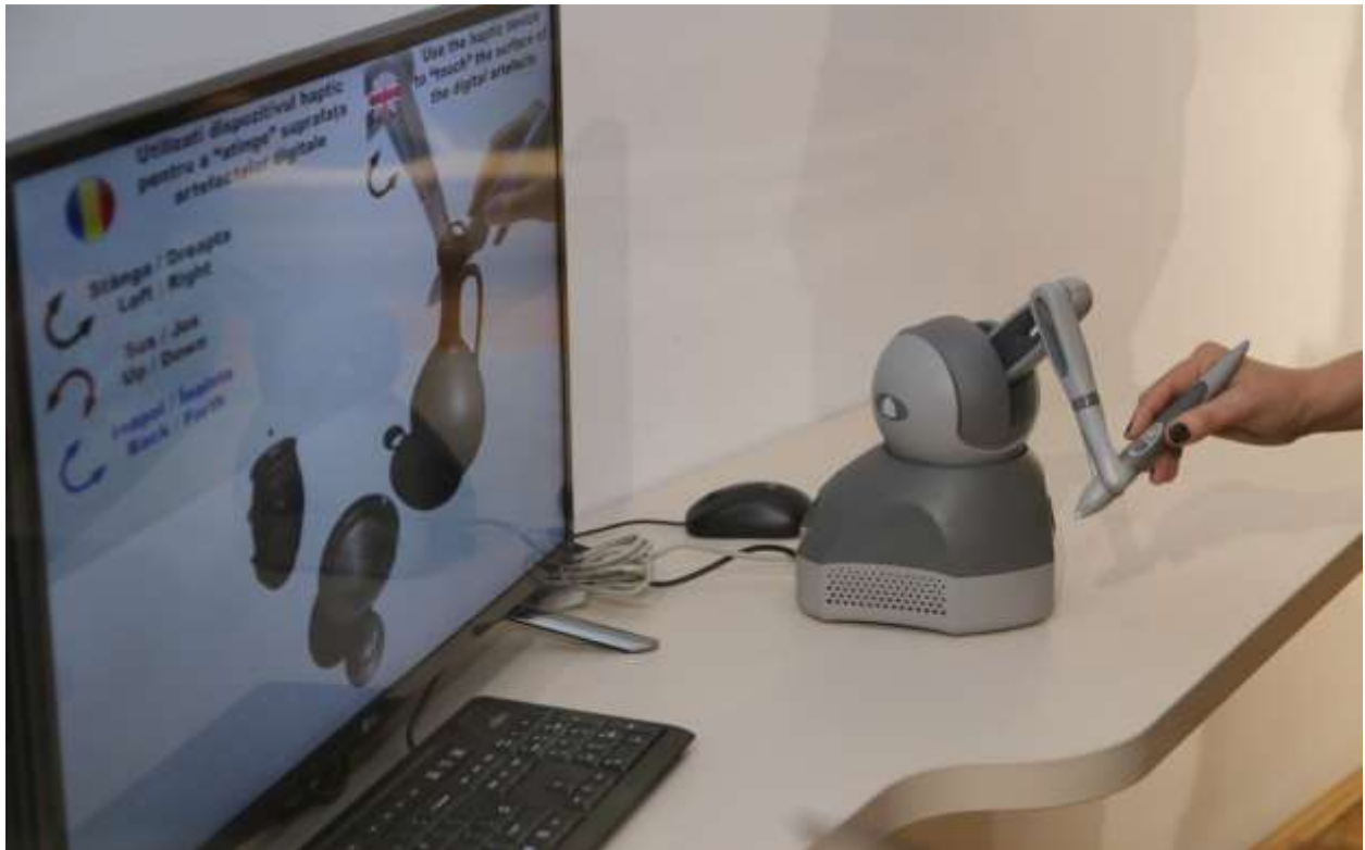
Slika 7. Haptički uređaj Geomagic Touch System. Izvor: Comes, 2016.
