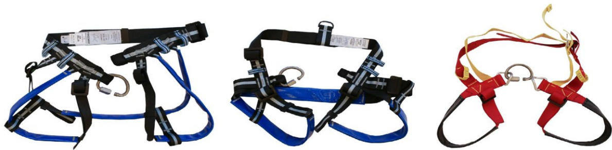
Abbildung 10.14 | Höhlengurte mit korrekt eingesetztem Halbrundkarabiner, die nach unten verschlossen sind. Dies ist beim Tragen eines Schleifsackes auf dem Halbrundkarabiner wichtig.
