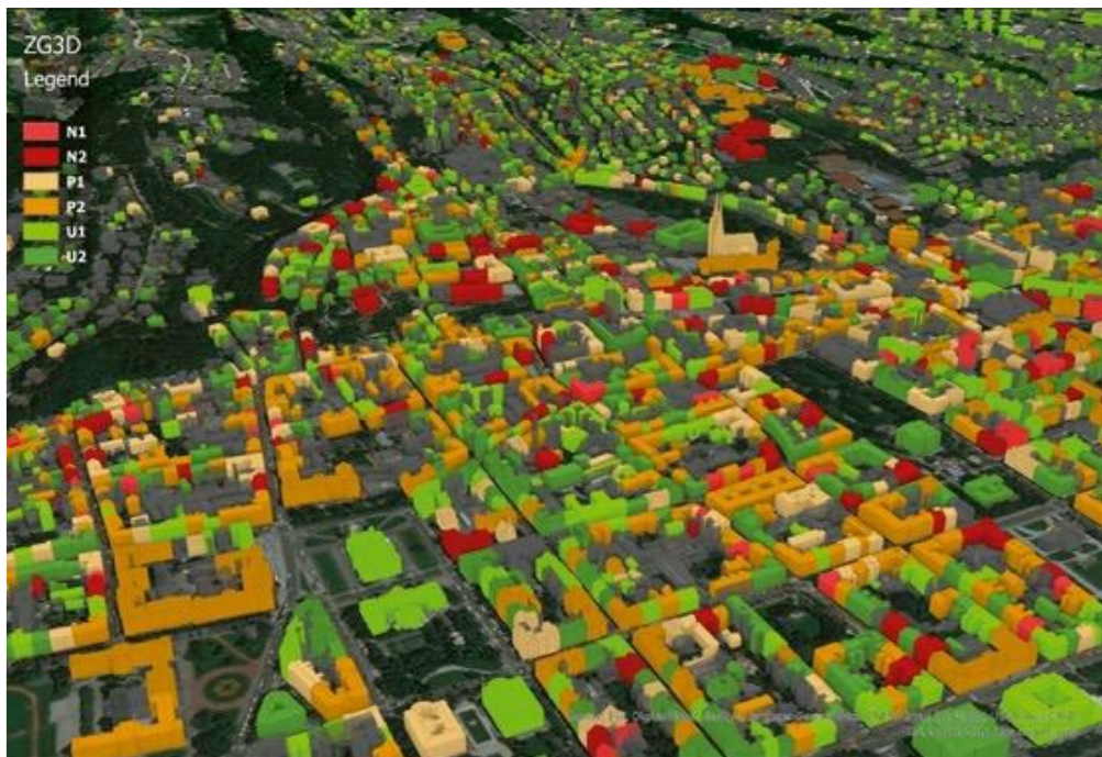
Slika 10. 3D prikaz oštećenja građevina Donjeg grada prema oznaci procjene uporabljivosti
