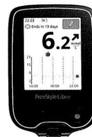
Slika 15.6. Čitač za kontinuirano mjerjenje šećera u međustaničnoj tekućini
