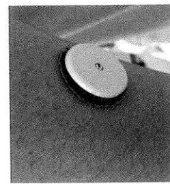
Slika 15.7. Senzor za kontinuirano mjerjenje šećera u međustaničnoj tekućini
