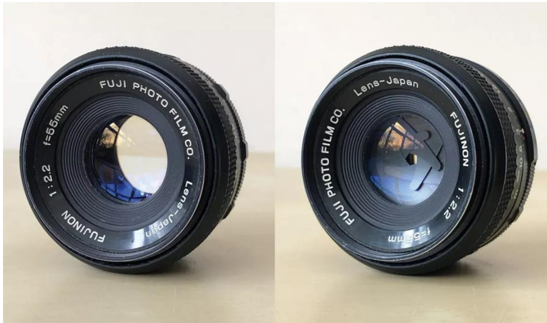
Slika 29. Primjer izgleda objektiva s potpuno otvorenom (lijevo) i potpuno zatvorenom blendom (desno) ( https://www.creativebloq.com/advice/a-beginners-guide-to-camera-aperture - pristupila 27.6.2023. u 15h)
