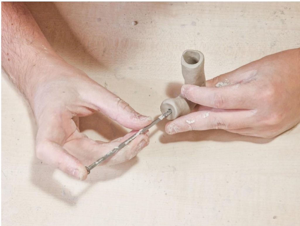
Slika 10. Bušenje rupe za kamiš pomoću metalnog alata
