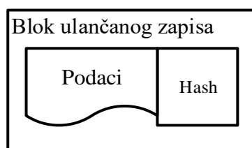
Slika 14. Struktura bloka ulančanog zapisa
