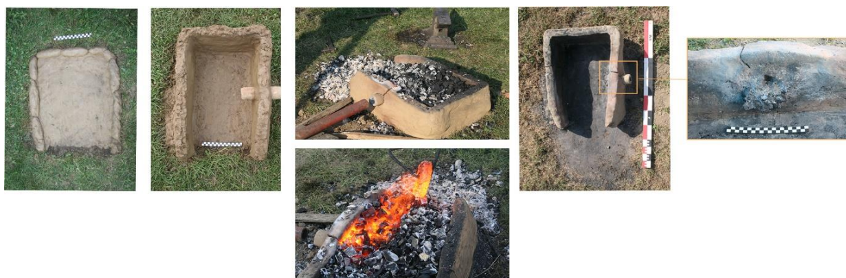
Slika 5.10. Eksperimentalna rekonstrukcija peći pronađenih na lokalitetu Hlebine Dedanovice u kojima je izveden postupak primarnog kovanja. Prikazane su faze od izgradnje do stanja peći nakon postupka – vidljiva nakupina zgre podno sapnice s unutrašnje strane stijenke peći.
