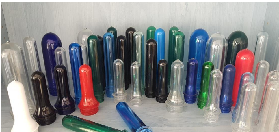
Slika 10: Plastične predforme Izvor: www.bosnaplast.com
