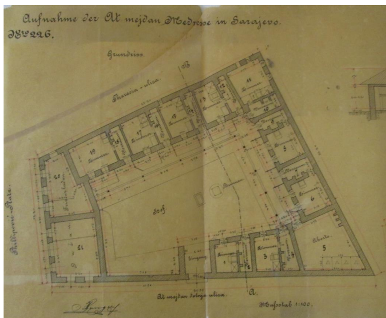
Slika br.58. Tlocrt prizemlja zgrade medrese, 1:100, 1891.
