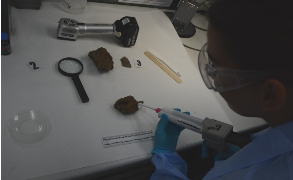
Slika 8. Postupak ispunjavanja površina na kojima su vidljivi tragovi linija silikonom
