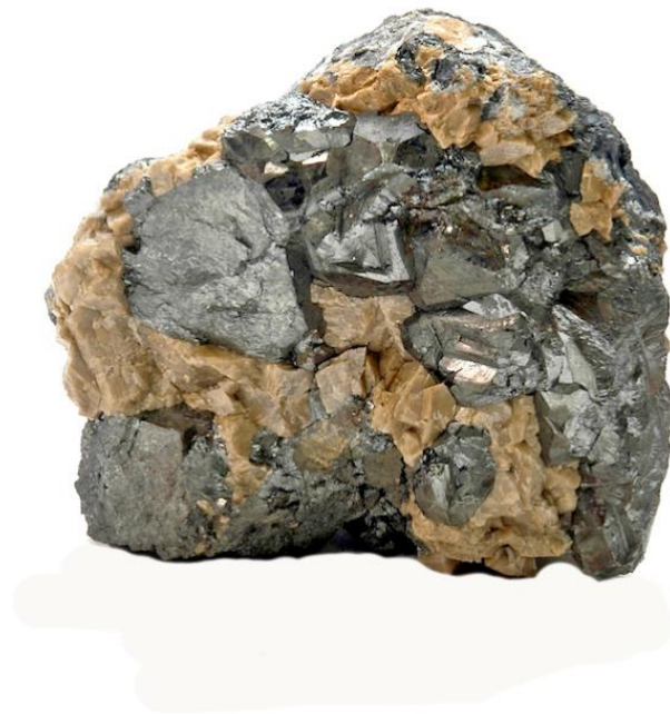
Slika 3: Tetraedrit sa sideritom, Maškara kod Gornjeg Vakufa, Bosna i Hercegovina (preuzeto od Pravidur 2014: 32)
