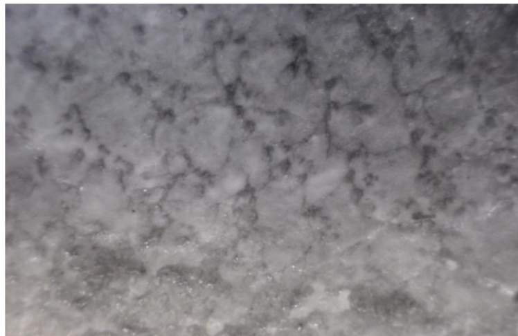
Sl. 10. Struktura površine izvorne kože s Dubrovačkog statuta povećana 200 puta IR elektronskim mikroskopom
